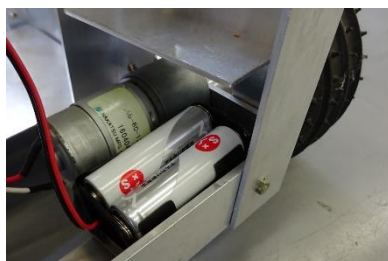
(写真-f) 受信機用電源ボックス
